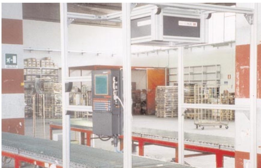
Stazione omni DS8100 con controllore SC8000
